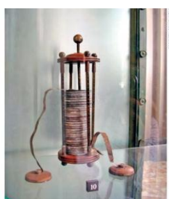
Pilha de Volta, formada por discos de cobre e zinco intercalados por pedaços de tecido embebidos em salmoura, exposta no Tempio Voltiano (museu dedicado a Alessandro Volta, em Como, Itália). Pela primeira vez a humanidade produzia corrente elétrica.
