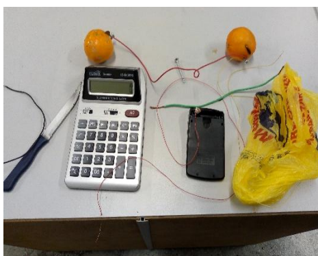
Figura 1. Calculadora ligada nos limões
