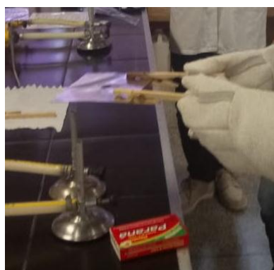
Figura 1 – Estudantes aquecendo a chapa de metal com furo no centro.
