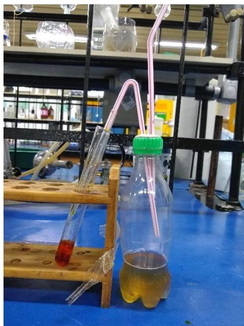
Figura 1 - Montagem do etilômetro caseiro.
