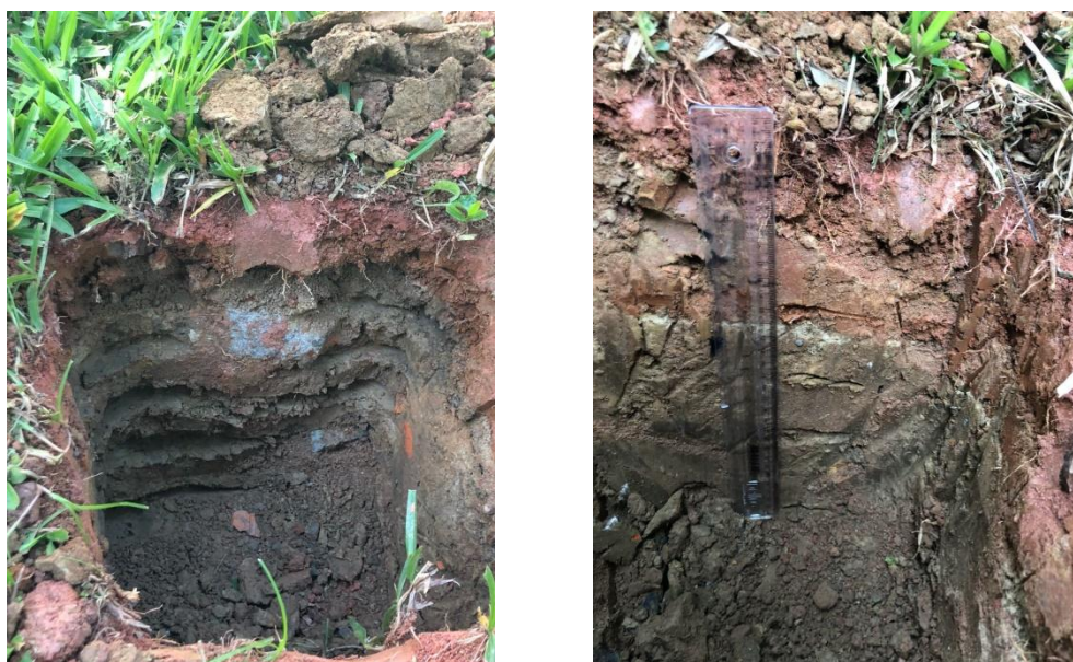
Figura 1: Primeira etapa prática: coleta do solo na área dos canteiros de amostragem de diferentes profundidades em uma das trincheiras abertas.
