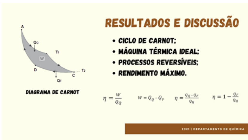
Figura 2: Ilustração do Ciclo de Carnot e principais equações para determinação do rendimento da máquina térmica. Diagrama disponível em Souza et al. (2019).
