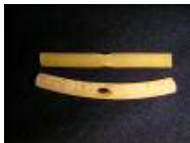
Figura 1. Mangueiras de látex com cortes na vertical
