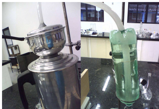
Figura 2: Cuscuzeira de “bondade” utilizada para fomentar o destilador (a esquerda) e condensador de garrafa PET de dois litros (a direita).
