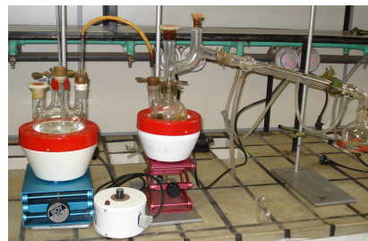
Figura 1: Sistema para destilação por arraste a vapor do óleo essencial de cravo – eugenol.
