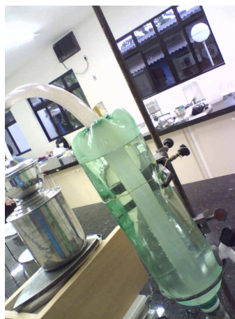
Figura 3: Observe a torneira de rosca na parte inferior do condensador (saída de água), vedada com durepox, assim como a parte inferior (“boca da garrafa”). Na parte superior do condensador, ao lado da mangueira que atravessa a garrafa, encontra-se a entrada de água.
