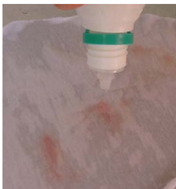
Figura 18: Aplicação de água oxigenada sobre a mancha
