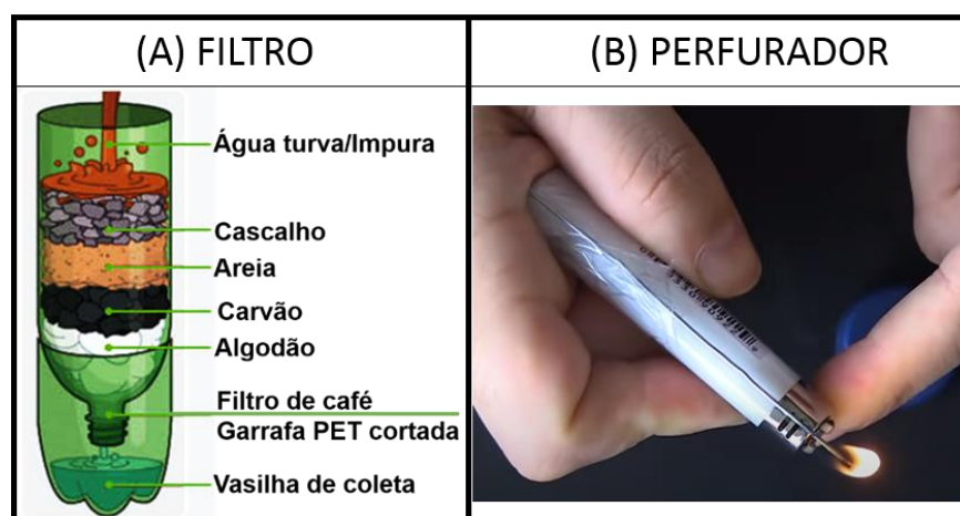
Figura 2. (A) Camadas do filtro. (Adaptado de SUSTENTÁVEL, 2018) (B) Ferramenta para perfurar o plástico. (Adaptado de CAVALLINI, 2017)
