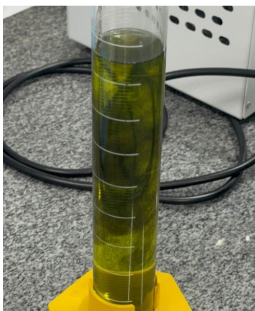
Figura 4: Extrato da Hortelã-Pimenta diluída em água com adição de 2 gotas de solução de 2% (m/v) de Cloreto Férrico ( \text{FeCl}_3 ).
