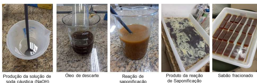
Figura 2: Processo de produção de sabão.
