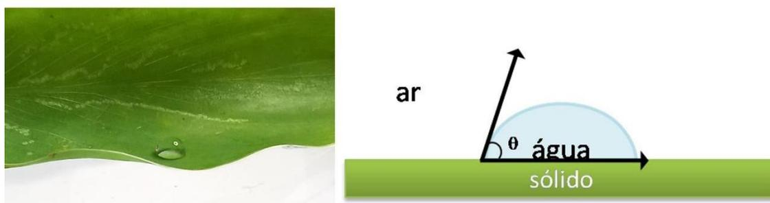
Figura 1: Imagem de uma gota de água numa folha e a medida do ângulo de contato.
