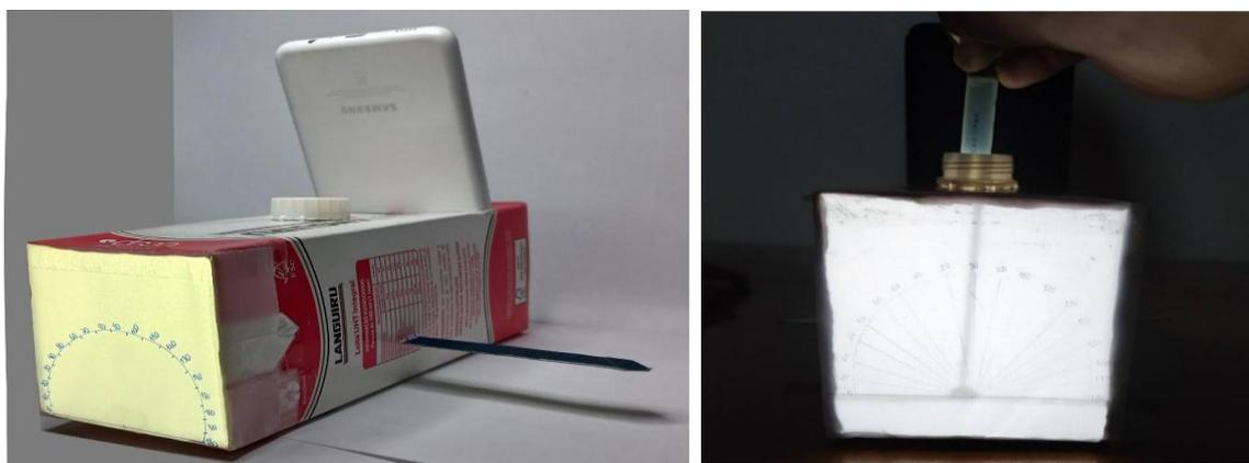
Figura 4: Demonstração do líquido sendo depositado na superfície e leitura do ângulo de contato. Fonte: AUTORES.
