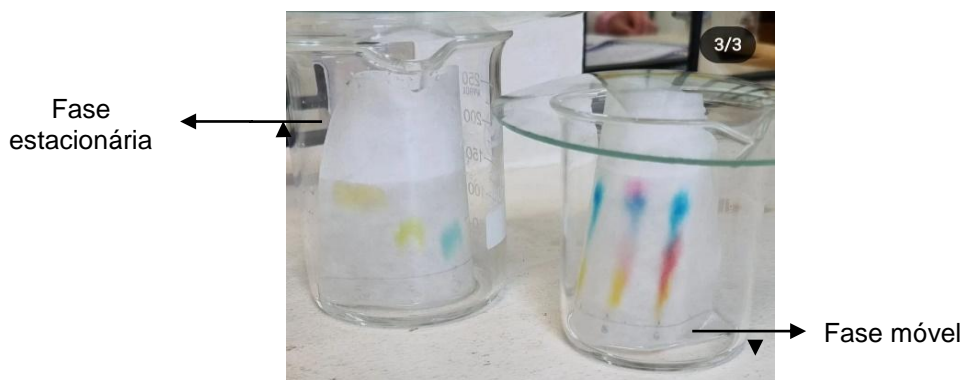
Figura 2: Representação de uma cromatografia em papel.
