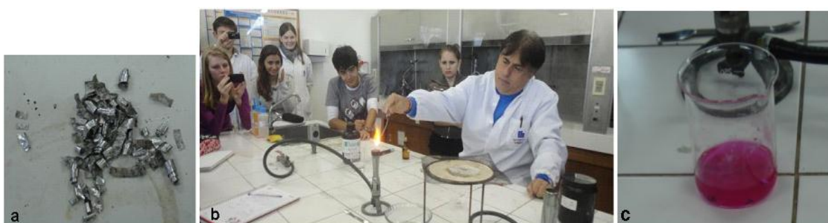
Figura 2: Experimento abordou uma Reação de Combustão. a) Raspas de magnésio foram utilizadas no experimento. b) As raspas de magnésio sofreram combustão (queima) em contato com a chama. O professor de Química explica as reações químicas que ocorrem no experimento através de demonstração prática. c) O experimento prosseguiu com a introdução do óxido de magnésio anteriormente formado, em copo de Becker contendo água. Esta reação produziu solução básica de hidróxido de magnésio, que reagiu com fenolftaleína tornando a solução rósea.
