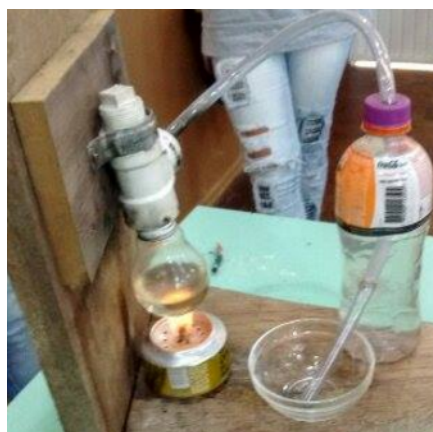
Figura 1: Destilador confeccionado por um do grupos. Fonte: dos autores 2016.
