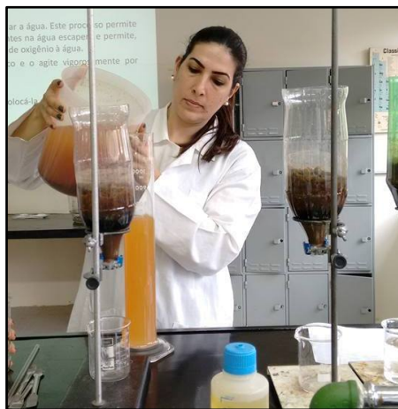
Figura 2: Imagem da utilização do filtro de água construído com material alternativo.
